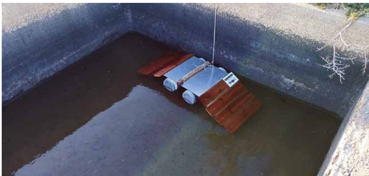
Εικόνα 13: Τοποθέτηση πλωτής διάταξης διαφυγής του LIFE Bonelli eastMed σε τιμεντένια δεξαμενή με κάθετα τοιχώματα. LIFE Bonelli eastMed©Αρχείο ΠΚ-ΜΦΙΚ.
